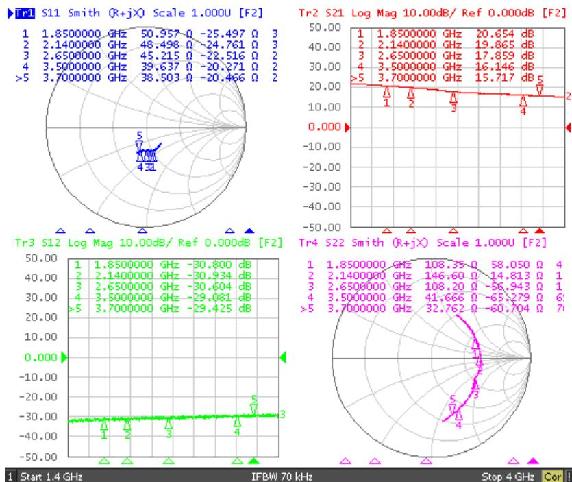
S-parameters ( $V_d=3.0V$ ,  $I_d=34mA$ ,  $T=25^\circ C$ )
